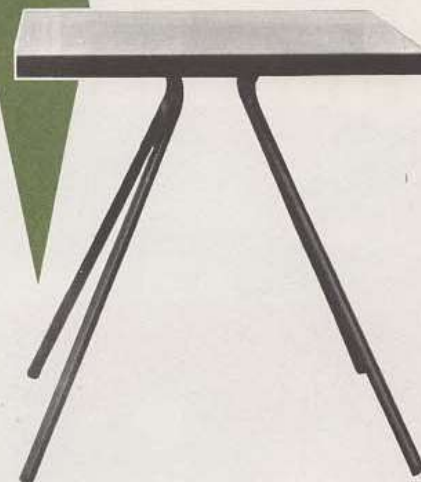
RÉF. 2059 GUÉRIDON DE RESTAURANT Dessus carré 700 x 700 Revêtement matière plastique stratifiée Bordures tombantes. Haut. 750 Ossature tubes émaillés au four de diam. 25 mm
