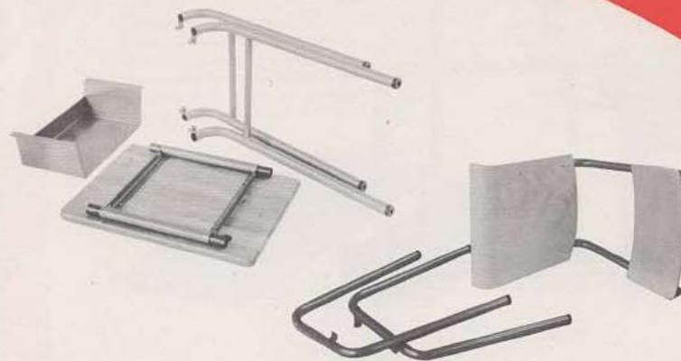
RÉF. 1073 E TABLE SIMPLE A SIÈGE INDÉPENDANT DÉMONTABLE Ossature tubes émaillés au four de diam. 32 mm Dessus lamellé hêtre verni de 21 mm d'épaisseur Avec ou sans casier porte-livres empilable
